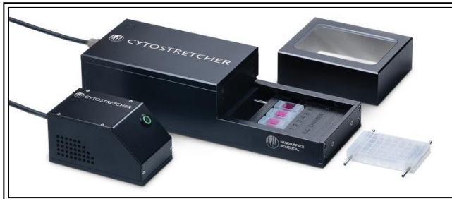
איור 1- מכשיר ה-CytoStretcher. הכולל צלחות סיליקון שניתן לגדל עליהן תאים ובעזרת מוטות מתכת המחוברות בצדדים המכשיר יכול למתוח את צלחת הסיליקון ואת התאים הצמודים אליה. מקור: https://www.curibio.com/instruments/cytostretcher
